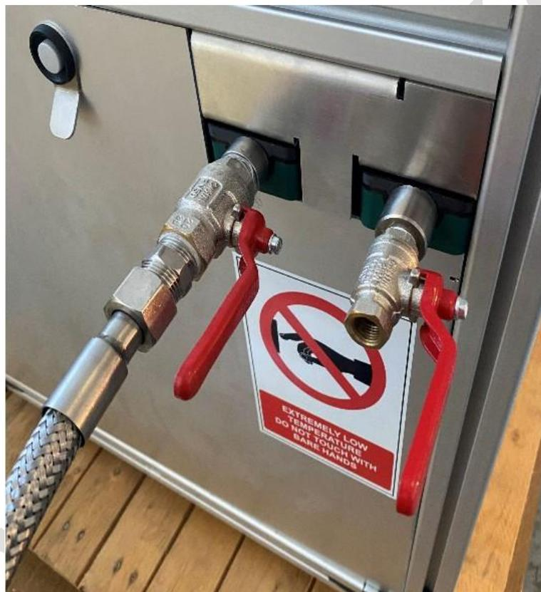
Vanne d'alimentation CO2 à gauche, vanne de dépressurisation à droite.
